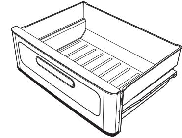
Используется для хранения овощей и фруктов, при этом обеспечивается постоянный уровень влажности внутри ящика.
